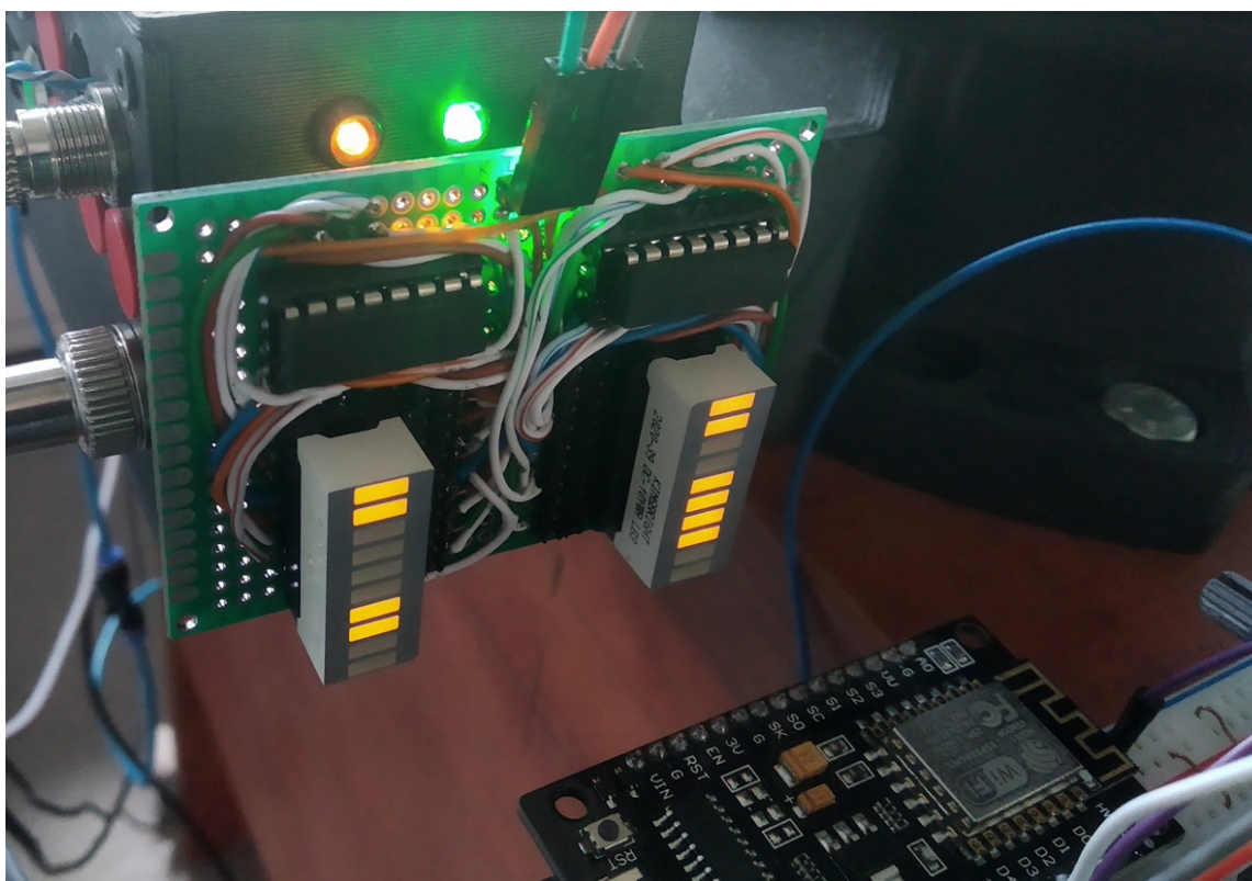
Podłączone mikrokontroler, płytka z modułami PCF oraz robot
